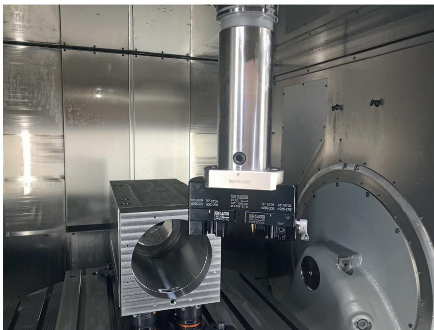
1 Beim Bearbeiten von Spindelgehäuse-Lagerbohrungen setzt SPL auf Technologie von BIG Daishowa, zum Beispiel Brückenwerkzeuge der Serie 318 von BIG Kaiser, mit denen SPL Bohrungen bis 800 mm Länge und 60 bis 400 mm Durchmesser spindelt © BIG Daishowa
